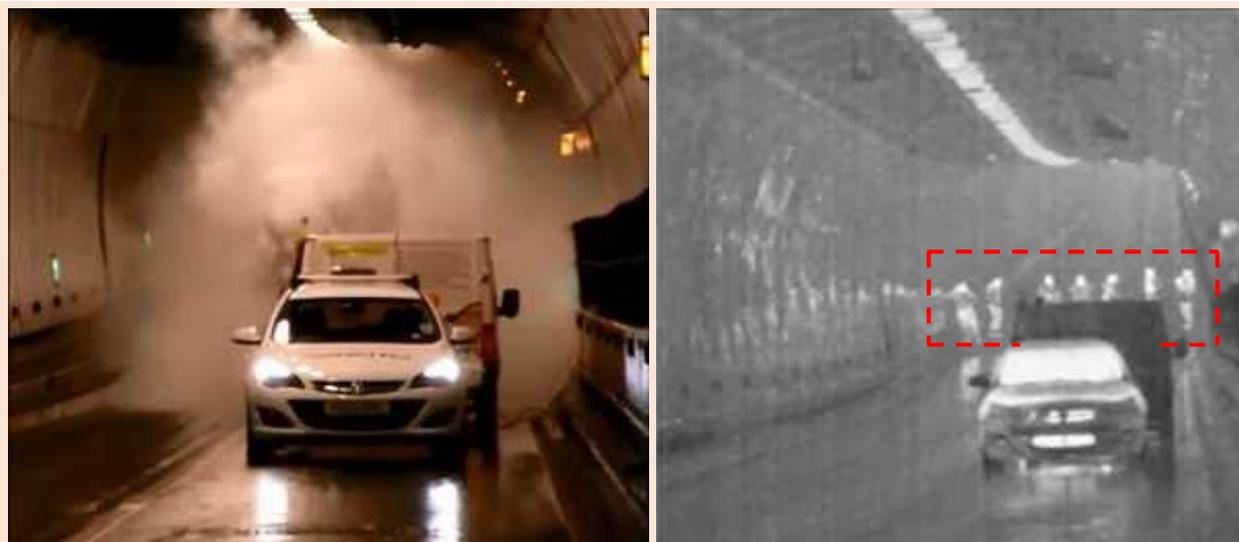
可視光カメラ(左)と、赤外線カメラ(右)の比較写真
